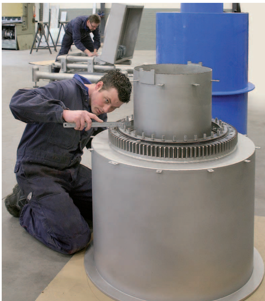
Ewout van Leeuwen en Frans Haverkamp van Bac Machinebouw werken aan een mengtrommel voor geraspte kaas.
